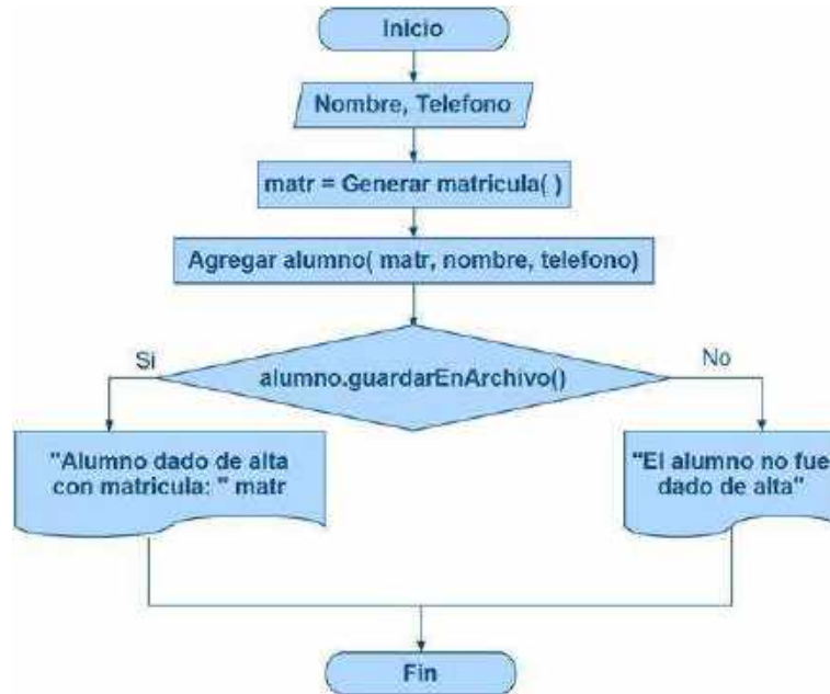
Figura 11-7: Diagrama de flujo del algoritmo para dar de alta a un alumno
