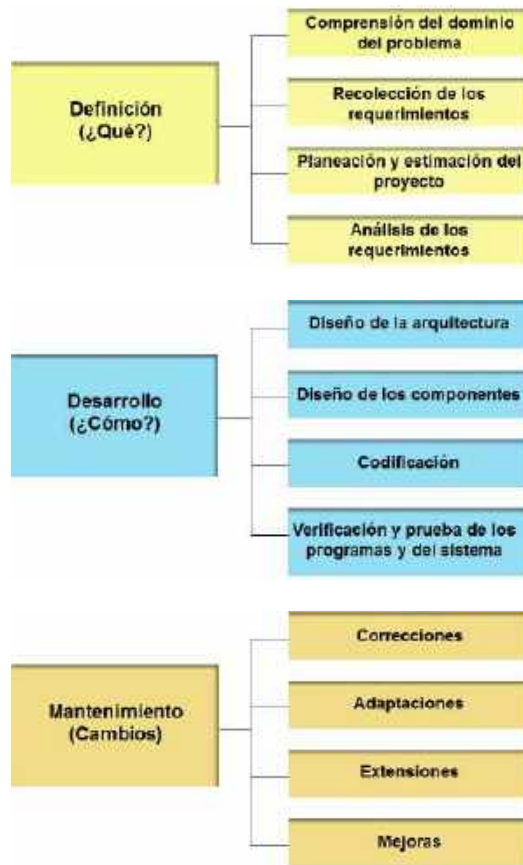
Figura 2-5: Las actividades de la definición, el desarrollo y el mantenimiento del software
